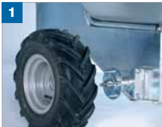
1 Stabile 4-Loch-Radaufnahme. Einfache und schnelle Montage.
